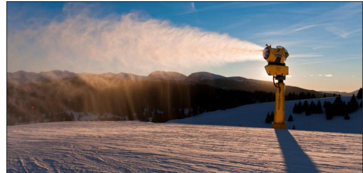
Abbildung: Beispielbild für einen Schneeerzeuger; Quelle: <http://www.technoalpin.com/>
